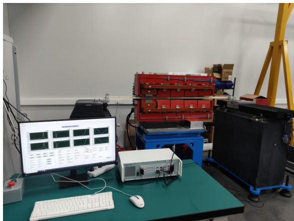
图5 平移长线圈磁测系统
